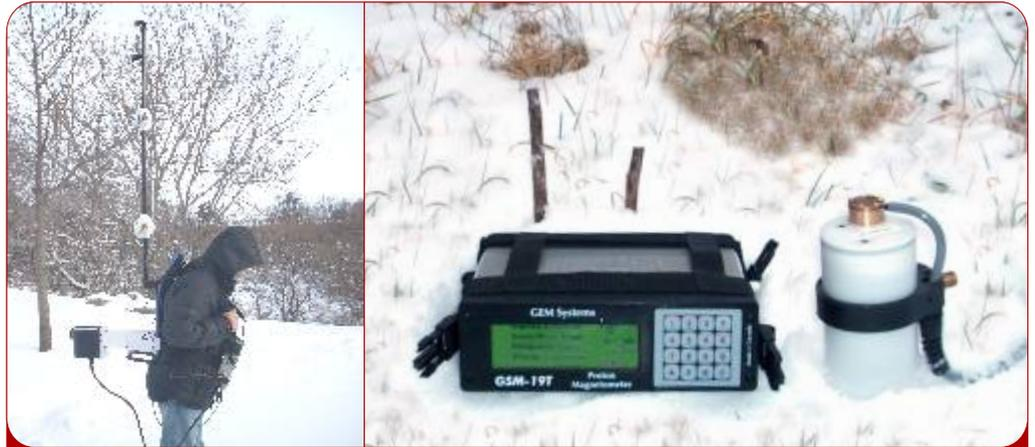
La consola del Precesión de Protones GSM-19TGW, viene con mochila, sensor adicional para lecturas del gradiómetro (simultáneos), sistema de GPS incorporado y sistema VLF EM
